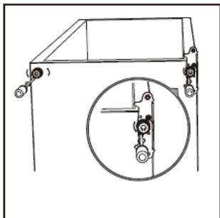
5. Deșurubați și scoateți bolțul balamalei inferioare, întoarceți placa de fixare și reintroduceți bolțul.
