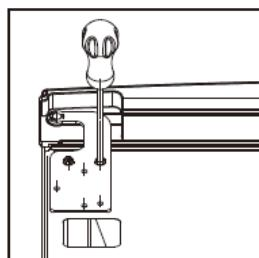
2. Emelje fel, majd lapos csavarhúzó segítségével távolítsa el a műanyag fedelet és a vezeték hüvelyét. Kérjük, vigyázzon a belül található vezetékre. Majd a vezetéket a csatlakozóaljzattal helyezze a másik oldalra, a vezetékhüvelyt szerelje át a másik oldalra, és rögzítse a helyére a fedelel.
