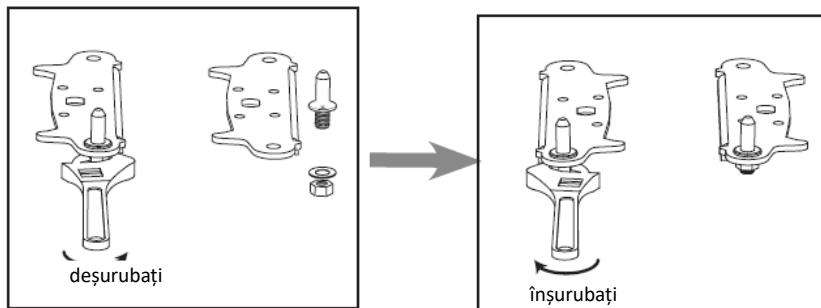
6. Montați la loc placa de fixare. Montați la loc picioarele reglabile. Mutați ușa inferioară în poziția corespunzătoare.
