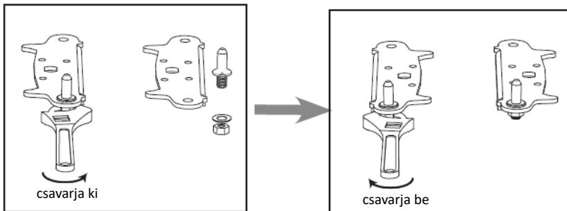
6. Szerelje vissza a rögzítő lemezt. Szerelje vissza az állítható lábakat. Az alsó ajtót helyezze a megfelelő pozícióba.
