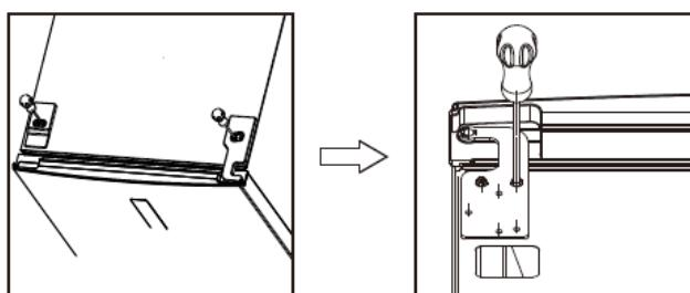
2. Ridicați și scoateți capacul din plastic și manșonul firului cu ajutorul unei șurubelnițe în linie. Vă rugăm să aveți grijă la firul din interior. Apoi mutați firul cu conector pe cealaltă parte, montați manșonul de fir pe cealaltă parte și fixați la loc capacul.
