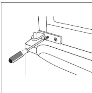
9. Montați ușa superioară, fixați balamaua superioară pe carcasa și conectați firul.
