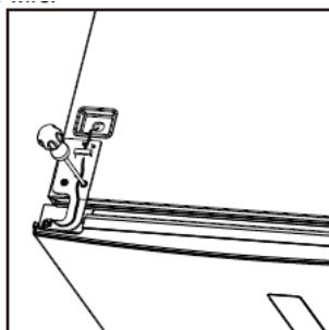
10. Scoateți capacul balamalei pentru stânga din punga cu accesorii și montați-l pe balamaua superioară. Apoi montați capacul pentru orificiu pe partea dreaptă.
