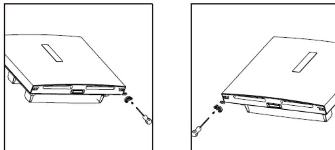
8. A központi zsanért fordítsa el 180 fokkal, majd rögzítse a bal oldalt a megfelelő pozícióba. A középső zsanér tengelyét helyezze az alsó ajtó felső nyílásába, majd csavarokkal rögzítse csavarokkal.
