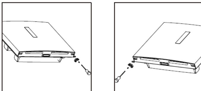
8. Întoarceți balamaua centrală la 180 de grade, apoi fixați-o în poziția corectă din partea stângă. Introduceți axul balamalei centrale în orificiul de sus al ușii inferioare, apoi strângeți șuruburile.
