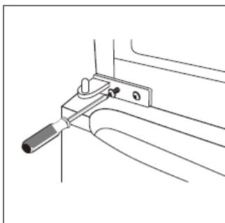
9. Szerelje fel a felső ajtót, a felső zsanért szerelje a burkolatra, és csatlakoztassa a vezetéket.
