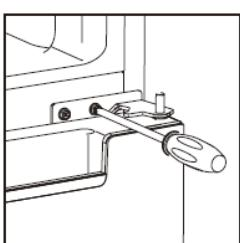
4. Așezați aparatul pe spate, scoateți picioarele reglabile aşa cum este indicat în imaginea de mai jos, apoi scoateți balamaua inferioară cu ajutorul șurubelnitei în cruce.
