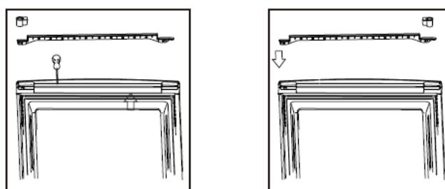
3. Desfaceți balama centrală cu ajutorul unei șurubelnițe în cruce, apoi scoateți ușa inferioară.
