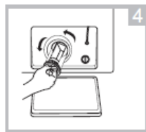
Oramutató járásával ellentétes irányba csavarva távolítsa el a szűrőt
