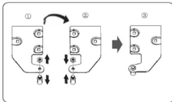
4. Scoateți ușa de pe balamaua inferioară. NOTĂ: În momentul scoaterii ușii, aveți grijă ca șaiba sau șaibele dintre balamaua inferioară și partea inferioară a ușii inferioare să nu rămână lipite de ușă. Nu le pierdeți.
