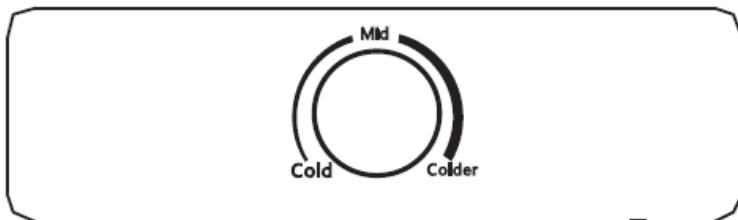
Бутона за управление на термостата, разположен в контролния панел, регулира температурата на фризерното отделение.
