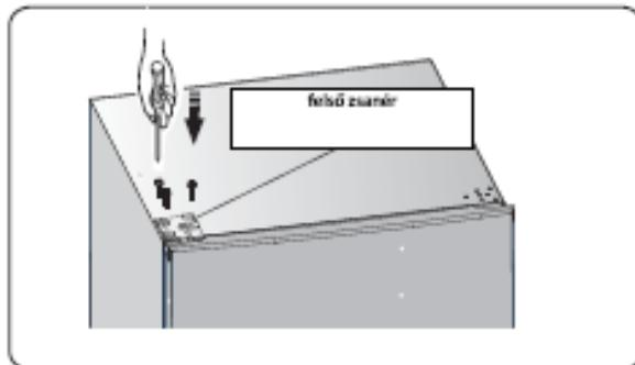
10. Szerelje fel a készülék jobb felső sarkánál levő nyílás fedelét. Szerelje fel a felső zsanér födelét (a műanyag zacskóban találja) a bal oldali sarokra és csavarokkal rögzítse. Tegye a felső zsanér födelét a műanyag zacskóba.
