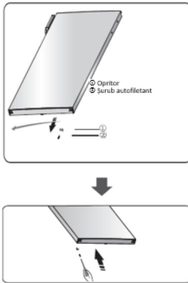
6. Așezați aparatul pe un ambalaj din spumă moale sau pe un material similar. Scoateți ambele picioare reglabile, apoi scoateți balamaua inferioară prin desfacerea șuruburilor speciale autofiletante cu flanșă.
