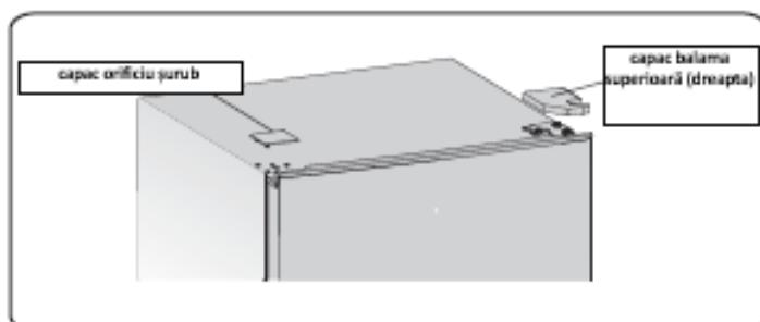
2. Cu ajutorul unei șurubelnite tubulare de 8 mm sau al unei chei, desfaceți șuruburile autofiletante speciale cu flanșă care sunt utilizate pentru fixarea balamalei superioare din dreapta (vă rugăm să susțineți ușa superioară cu mâna în timpul acestei operații).
