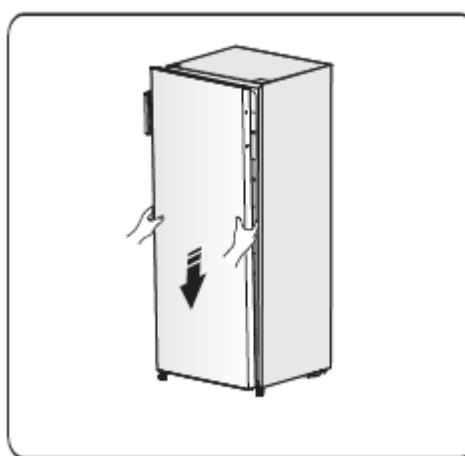
9. Mutați balamaua superioară și introduceți axul balamalei superioare în orificiul de sus al ușii, apoi reglați poziția ușii (vă rugăm să susțineți ușa cu mâna în timpul acestei operații), fixând balamaua superioară cu ajutorul șuruburilor speciale autofiletante cu flanșă.
