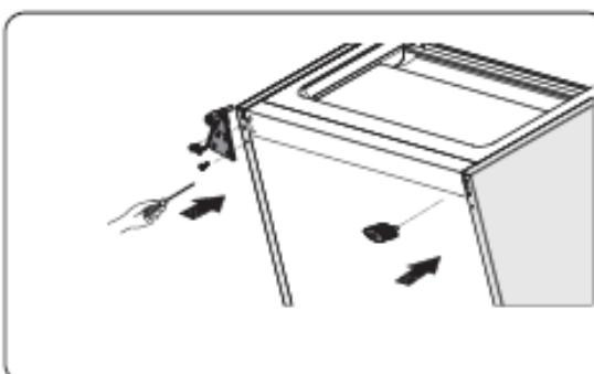
8. Așezați ușa în poziția corespunzătoare, reglați balamaua inferioară și introduceți axul balamalei în orificiul de jos al ușii.
