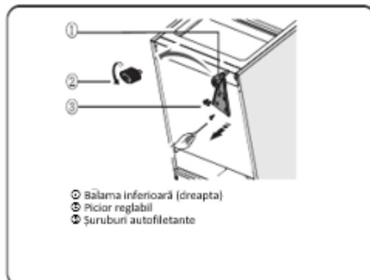
7. Repozitionați balamaua inferioară pe partea stângă și fixați-o cu ajutorul șuruburilor speciale autofiletante cu flanșă. Poziționați picioarele reglabile în partea opusă și fixați-le.
