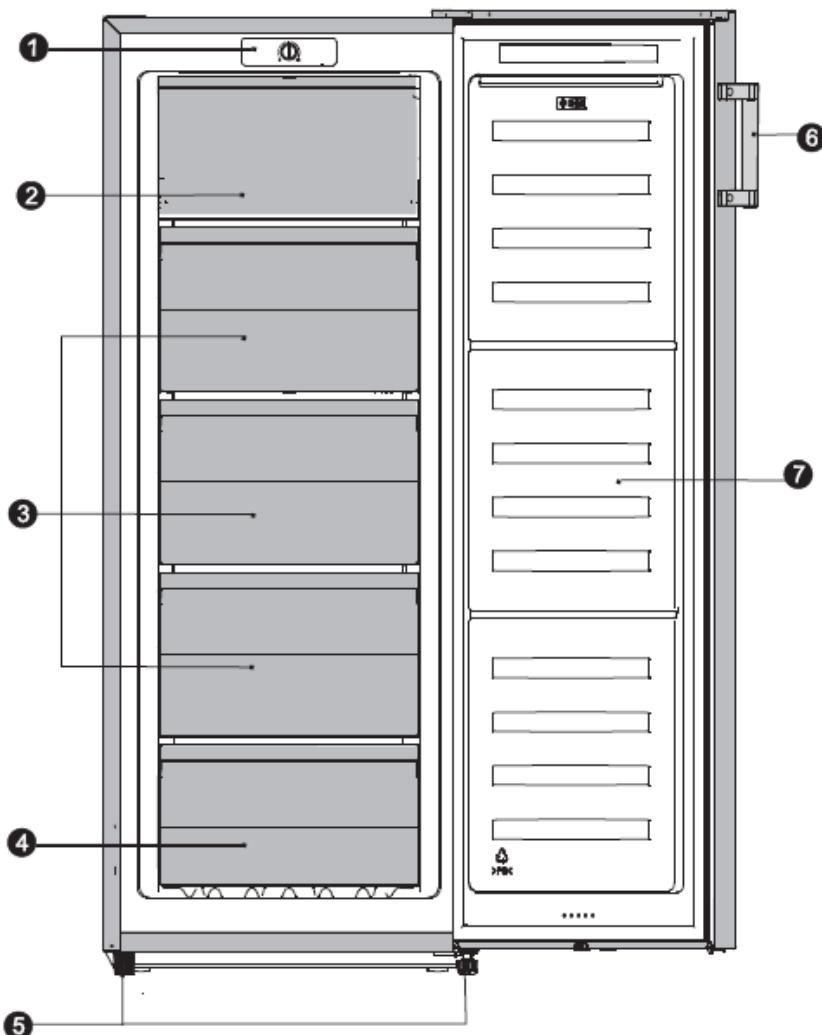
A termék legjobb energiahatékonyságának elérése érdekében kérjük, helyezzen el minden polcot, fiókot és kosarat eredeti helyzetükben, a fenti ábra szerint
