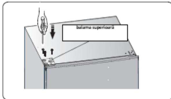
10. Montați capacul pe orificiul situat în colțul din dreapta sus al aparatului. Montați capacul balamalei superioare (aflat în punga din plastic) pe colțul din stânga. Puneți capacul balamalei superioare în punga din plastic.
