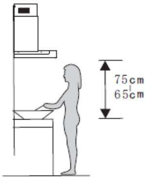
3. Montați tubul extensibil pe hotă, apoi puneți hota în cârligul de prindere și aliniați-o. Apoi fixați-o cu șuruburi.
