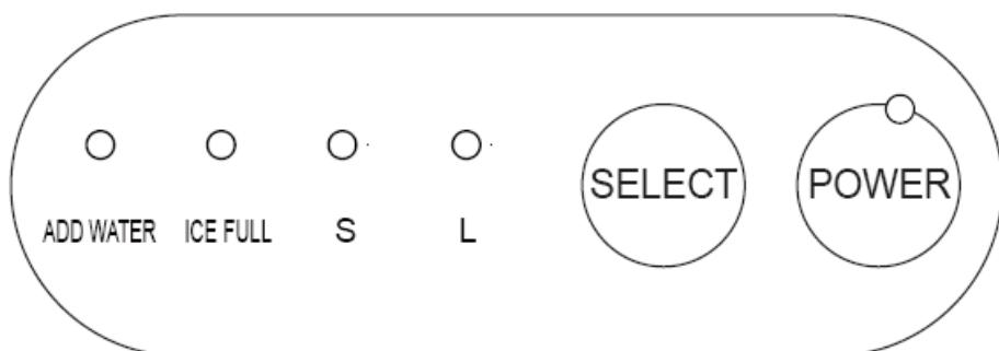
**POWER (INDÍTÁS)** – A készülék tápforráshoz való csatlakoztatása után a POWER jelző villogni kezd, majd a készülék a standby üzemmódra vált. A POWER gomb megnyomásakor a készülék működni kezd, a világító jelző pedig kigyűl. Ha a készülék működése közben megnyomja ezt a gombot, a készülék visszatér a standby üzemmódba.
