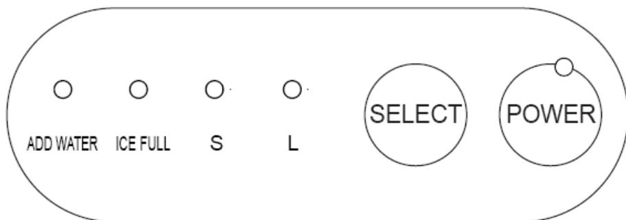
**POWER (PORNIRE)** - Indicatorul POWER se aprinde intermitent după conectarea ştecărului la sursa de alimentare, apoi aparatul intră în standby. Aparatul va începe să funcționeze la apăsarea butonului POWER, iar indicatorul luminos se va aprinde. În cazul apăsării acestui buton în timpul funcționării, aparatul va reveni la modul standby.
