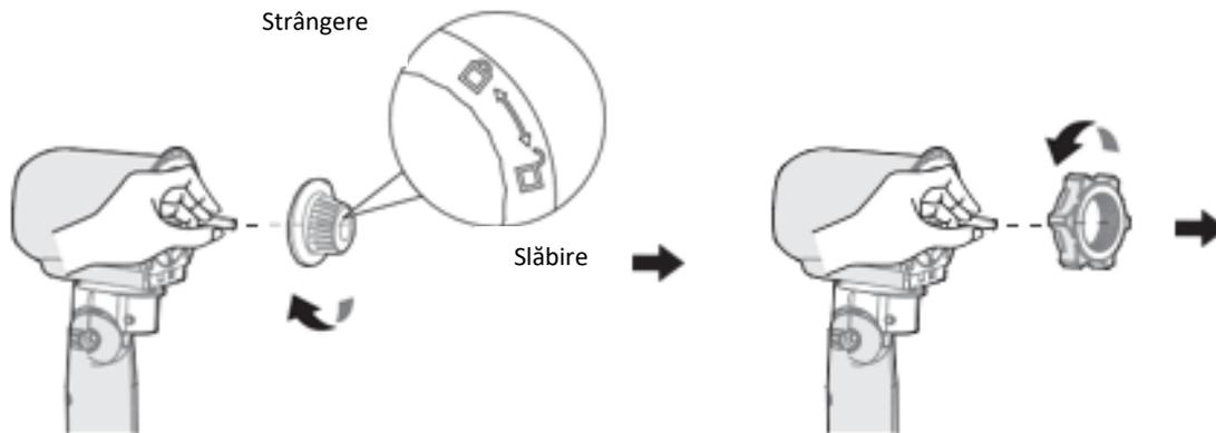
3.2. Prindeți grila de protecție posterioară pe motor; rotiți în sensul acelor de ceasornic piulița de fixare a grilei, pentru a fixa grila de protecție posterioară.
