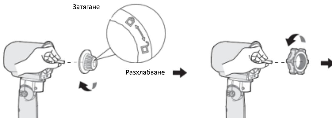
3.2. Прикрепете задната защитна решетка към двигателя; завъртете гайката за закрепване на решетката по посока на часовниковата стрелка, за да закрепите задната решетка.
