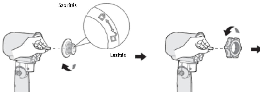
3.2. Erősítse a hátsó védőrácsot a motorhoz; az óramutató járásának megfelelő irányban forgassa el a rácsrögzítő anyát a hátsó védőrács rögzítéséhez.
