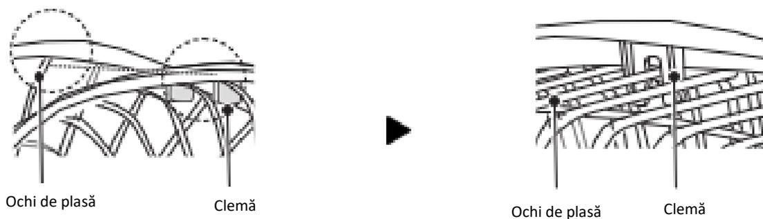
5.2. Apăsați pe grile cu ambele mâini, pentru a le îmbina. Fixarea corectă a acestora va fi indicată de un clic.
