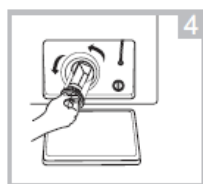
Óramutató járásával ellentétes irányba csavarva távolítsa el a szűrőt
