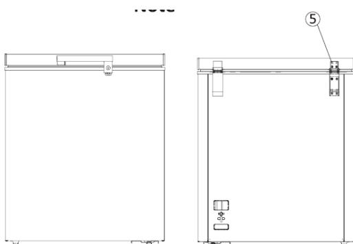
**MEGJEGYZÉS:** Ha a fogantyú felszerelése során a zárszerkezet gyűrűje nem tartotta meg a zárat, kérjük csavarja ki a kerekfejű csavarokat (5) az ajtó hátsó részéből és állítsa be az ajtó pozícióját fel vagy le. Ezt követően csavarokat tegye vissza a fogantyú rögzítéséhez.
