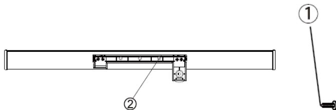
1. Vegye ki a fagyasztóláda szerkezetéből és ajtójából a 4 darab csavart (1) és szerelje le a záras fogantyú alját (2), a fogantyú fedőlapját (2) és a zárszerkezet gyűrűjét (1).
