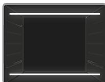
**Ventilátor funkció:** A sütő termosztátja és a figyelmeztető fényjelzései bekapcsolnak, a felső és az alsó fűtőelemek működésbe lépnek, illetve bekapcsol a ventilátor. Ez a funkció kiváló eredményt biztosít tészták sütésekor. A sütést az alsó és a felső fűtőelem, illetve a ventilátor által áramoltatott levegő végzi el, aminek köszönhetően egy kicsit megpirul az étel. Ajánlott a sütőt körülbelül 10 percig előmelegíteni.
