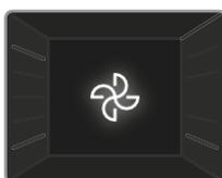
**Funcția Turbo:** Termostatul cuptorului și lămpile de avertizare se vor aprinde și elementul inelar de încălzire și ventilatorul vor începe să funcționeze. Funcția Turbo distribuie uniform căldura în cuptor, astfel încât toate alimentele de pe toate rafturile să fie gătite uniform. Se recomandă preîncălzirea cuptorului timp de aproximativ 10 minute.
