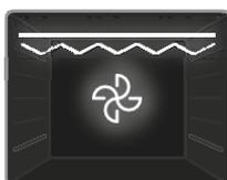
**! AVERTISMENT:** La folosirea grătarului ușa cuptorului trebuie închisă, iar temperatura trebuie reglată la 190°C.
