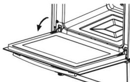
2. Deschideți închizătoarea (a) (cu ajutorul unei surubelnite până la poziția finală).
